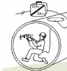
Los Equipos eléctricos y luminarias utilizadas deben estar protegidos mediante: utilización de tensiones de seguridad de 24 V, separación de circuitos y colocación del transformador en el exterior.
