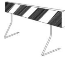
VALLA DE OBRA MODELO 1
