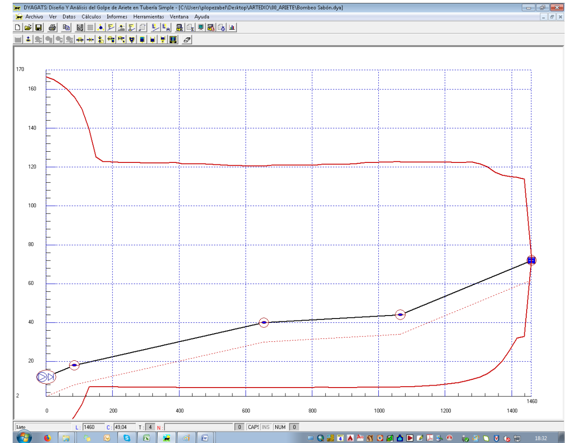
Envolvente de presiones sin anti-ariete EBAR de Sabón
