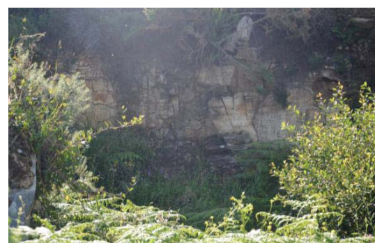
Foto 11.- Detalle de afloramiento rocoso algo más alterado (Grado IV)
