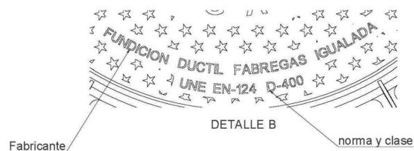
Material: Fundicion ductil GGG-40
